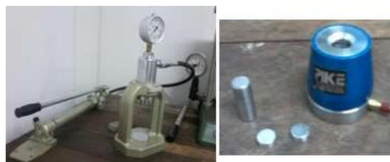
Figura 3 – Prensa peletizadora.
