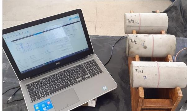
Figura 3: Execução do ensaio ultrassônico.
